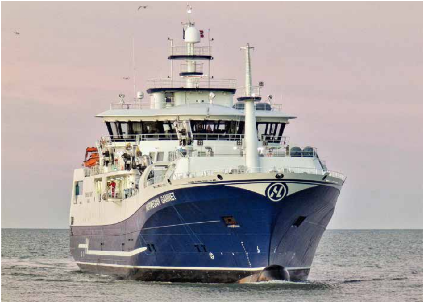
Av mange oppgaver man kan bli pålagt som styremedlem er f.eks. å være med på dåpen av verdens første slaktebåt – «Norwegian Gannet». Den ble overlevert i 2018, er hele 94 meter lang og 18 meter bred – har syv dekk og veier 4000 tonn. De 14 sløyemaskinene om bord kan sløye 25 fisk per minutt.
